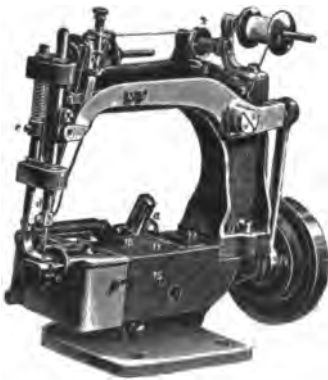
Fig. 65. Kettenstichnähmaschine zum Nähen der Köpfe der Glühstrümpfe.
