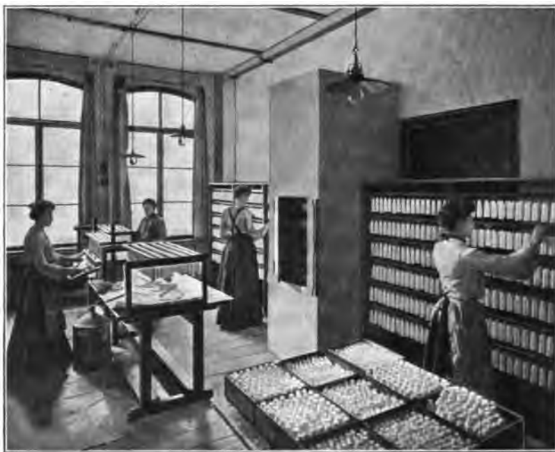
Fig. 113. Kollodinierraum mit Trockenschrank.
