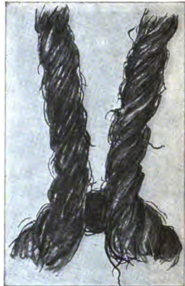
Fig. 129. Baumwolle, 70er, gehärtet, ganzer Aschenfaden, nach einer Brennstunde. 100fache Vergrößerung.
