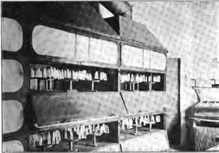
Fig. 115. Trockenschrank für kollodinierte Glühkörper.
