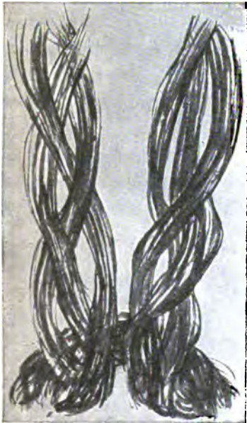
Fig. 136. Ramie, 60/3, abgebrannt, ganzer Aschefaden. 100fache Vergrößerung.
