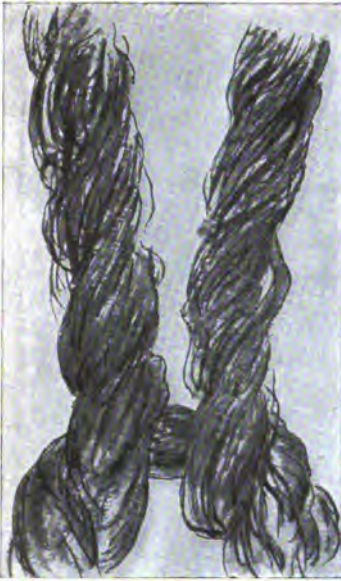
Fig. 128. Baumwolle, 70er, abgebrannt, ganzer Aschenfaden. 100fache Vergrößerung.
