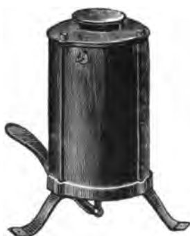
Fig. 108. Preßgasgebläse für Fußbetrieb.
