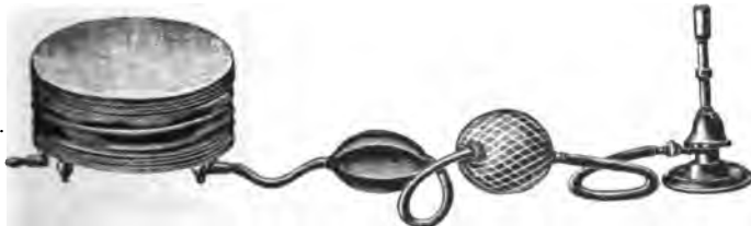
Fig. 93. Preßgasgebläse für Handbetrieb.
