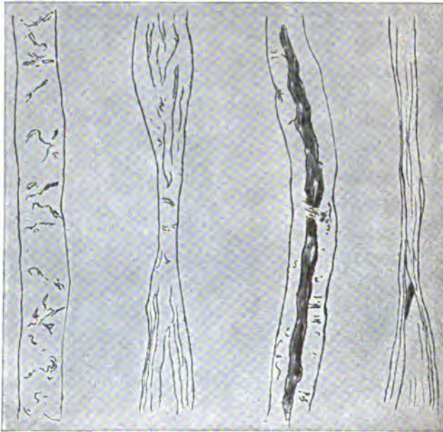
Fig. 131. Ramie, 60/3, Einzelfasern, roh. 240fache Vergrößerung.
