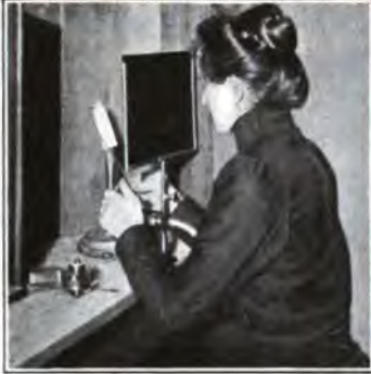
Fig. 99. Das Formen und Härten des Glühkörpers.
