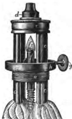
Fig. 262. Spiritus-Glühlichtlampe „Auer“. Vergaservorrichtung.
