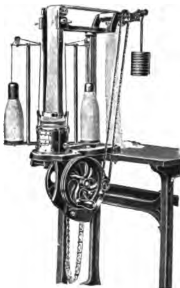
Fig. 57. Rundstrickmaschine für Handbetrieb mit automatischem Warenabzug. Apparat zum Fest- und Losestricken. Automatischer Wendeapparat.
