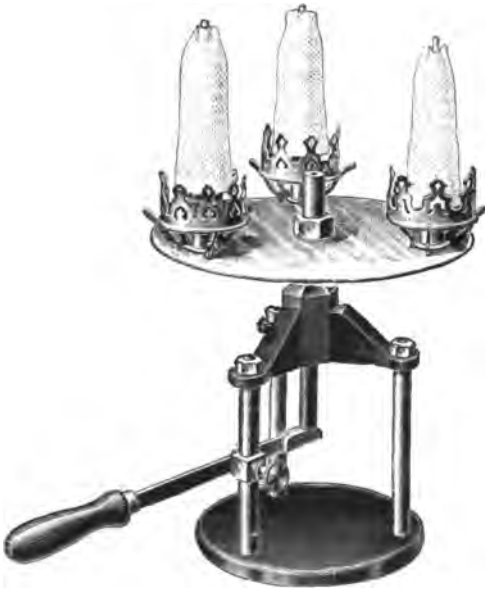
Fig. 122. Festigkeitsprüfer für Glühkörper.
