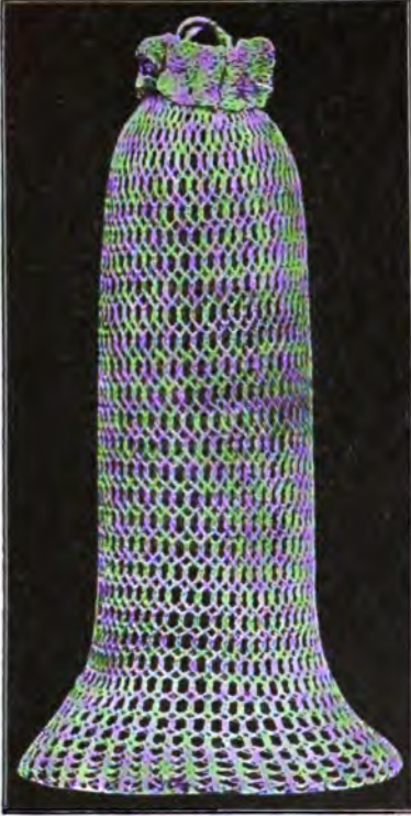
Fig. 42. Für Petroleumglühlicht. 80 mm lang. 31 mm Durchmesser.
