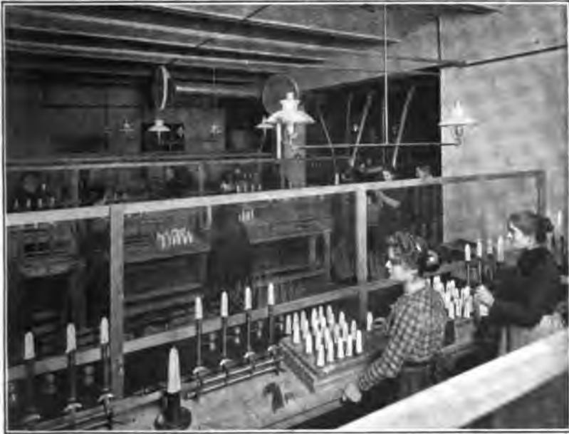
Fig. 87. Abbrennerei mit Abbrennmaschinen ausgerüstet.
