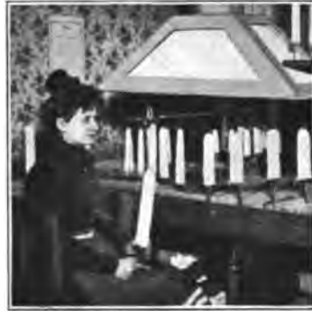
Fig. 92. Veraschen der Glühkörper.
