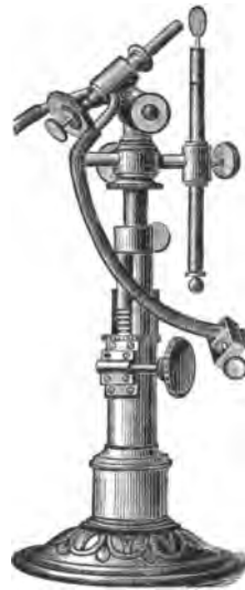
Fig. 10. Der Linnemannsche Brenner. Rechts oben vor der Mündung des Brenners das in Platin gefaßte Zirkonplättchen von einem verstellbaren vertikalen Arm getragen.
