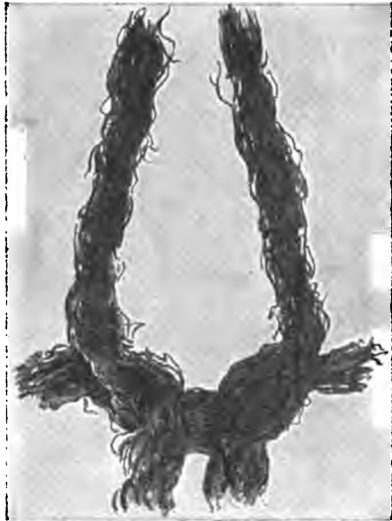
Fig. 130. Baumwolle, 70er, ganzer Aschefaden, nach 300 Brennstunden. 100fache Vergrößerung.
