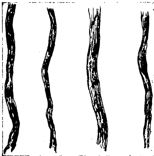
Fig. 134. Ramie, 60/3, gehärtet, nach einer Brennstunde. 240 fache Vergrößerung.
