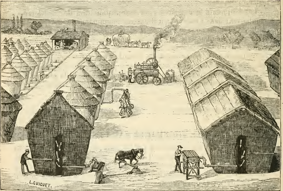
Fig. 12. — Dessiccation des meules par le système Neilson.
